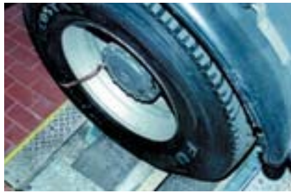
Leicht in den Rollensatz des Bremsenprüfstandes nachrüstbar: Die Messrolle für die Wegstreckenmessung
